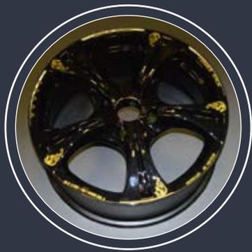
Mehrlagige Pulverbeschichtung und schichtgenauer Laserabtrag
