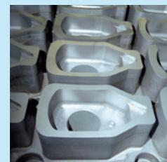
Beispiel Finishstrahlen (Verwendung von zwei unterschiedlichen Strahlmitteln zur Oberflächenverbesserung):
