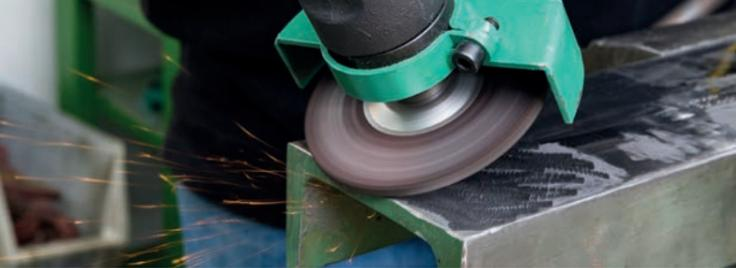
Mit dem WRD/H 10-20/3 S hat BIAX den kleinsten und leichtesten Winkelschleifer für Schleifscheiben auf dem Markt. Das Gerät kann mit Schleif- und Trennscheiben bis Ø 75 betrieben werden.
