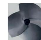
Diese Senker wurden speziell für die Verwendung mit Handmaschinen entwickelt. Die konvexen, ungleichen Radien der Schneiden mit variabler Spiralsteigerung, sorgen für einen besonders ruhigen, vibrationsarmen Senkvorgang. Ergebnis ist eine exakt runde und ratterfreie Senkung.
