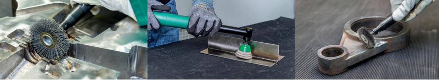
**Bürsten haben eine große Wirkung auf Kanten und überstehendes Material, ohne die eigentliche Kontur des Werkstücks stark zu verändern. Das macht sie zu einem hervorragenden Entgrat- und Reinigungswerkzeug.**
