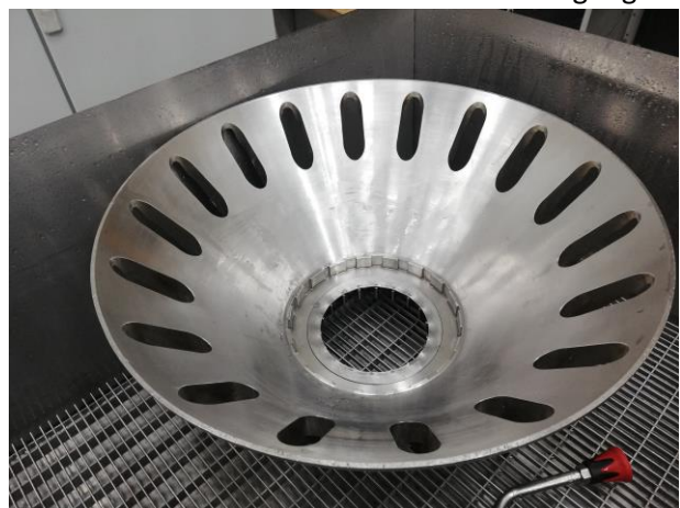
Abb. 1b: Verteilerteller – nach der Reinigung
