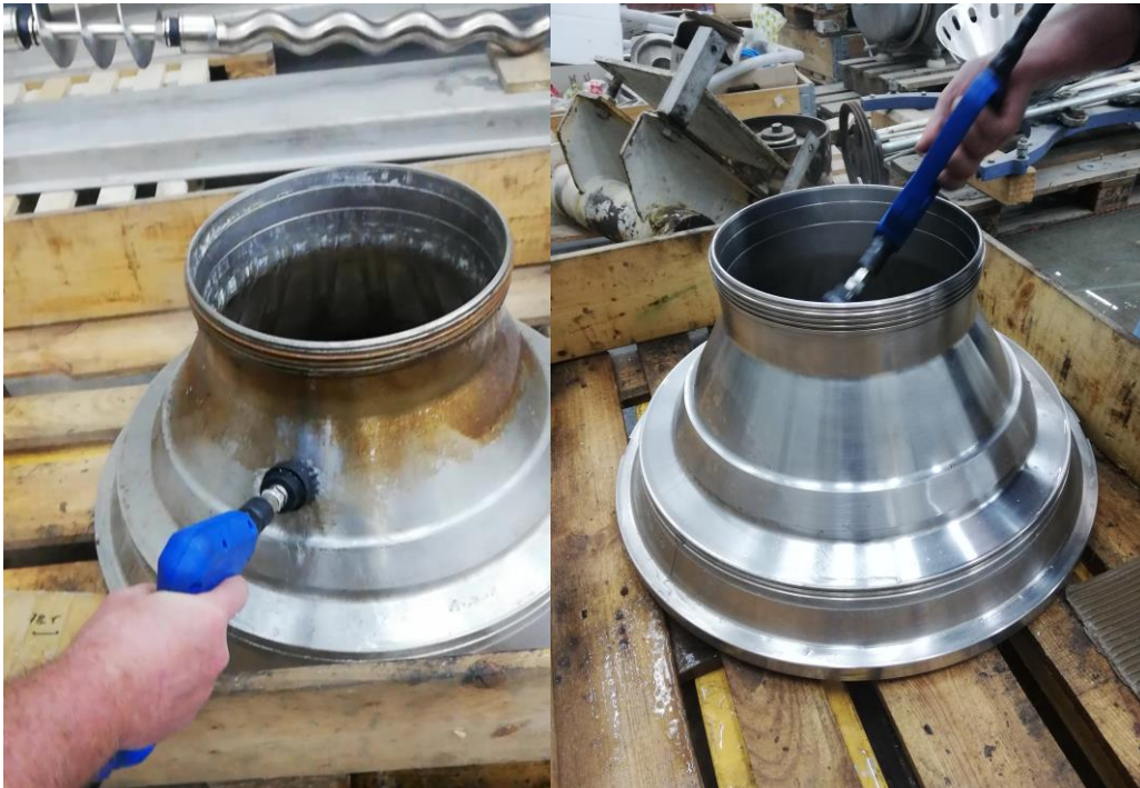
Abb. 2a und 2b: Reinigung eines Trommeldeckels mit 5m-Schlauch und Pinselbürste – vorher und 8 Minuten später
