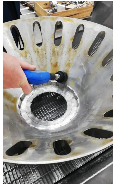
Abb. 1a: Verteilerteller, teilweise noch belegt mit Stärke und Gluten – während der Reinigung
